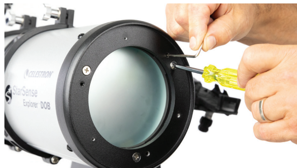
Figura 20: Per il telescopio da tavolo Dob 130, regolano l'inclinazione dello specchio primario tre set di viti tiranti. Allentare una vite della coppia e serrare l'altra per regolare l'inclinazione.
