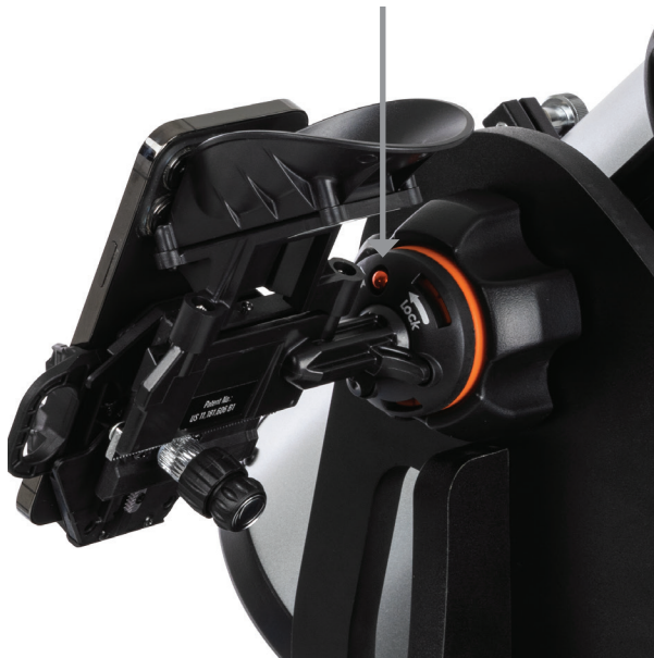
Figura 24: Para desconectar el conector StarSense de la base, pulse el botón de bloqueo naranja y gire el brazo del conector en sentido horario
