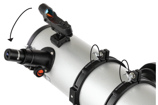
Figura 6a: Para rotar el tubo óptico para una posición del enfoque más ergonómica, afloje el(los) mando(s) de fijación en las anillas o el soporte del tubo.
