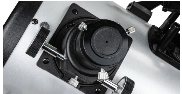
Figura 15: Para comprobar la alineación de los espejos, use el tapón de colimado incluido en el enfoque.
