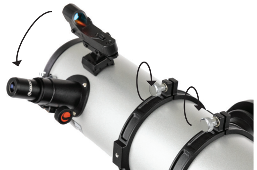
Abbildung 6a: Um den optischen Tubus für eine ergonomischere Fokussierposition zu drehen, lösen Sie einfach die Klemmknöpfe an den Tubusschellen oder der Halterung.
