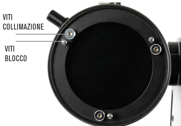
Figura 21: I telescopi da tavolo Dob 114 e 150 sono dotati di tre viti di collimazione caricate a molla che regolano l'inclinazione dello specchio primario. Le altre tre viti bloccano lo specchio una volta terminate le regolazioni all'inclinazione.
