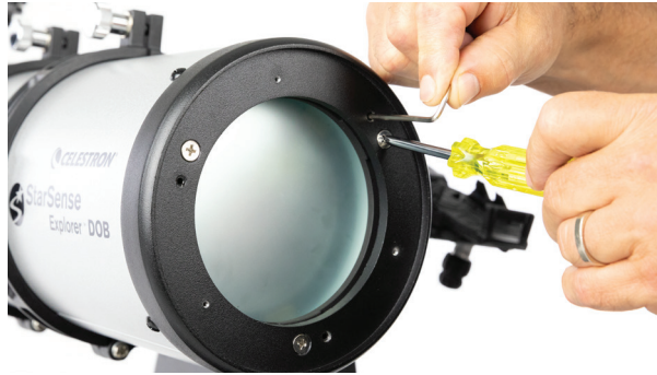
Abbildung 20: Beim 130 Tabletop Dob stellen Sie mit den drei Sätzen Push-Pull-Schrauben in der Spiegelzelle die Neigung des Hauptspiegels ein. Lösen Sie eine Schraube des Paares und ziehen Sie die andere fest, um die Neigung einzustellen.
