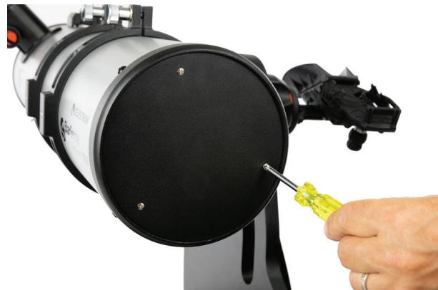
Figure 19a: Pour le Tabletop Dob de 130, retirez le cache arrière de la cellule du miroir
