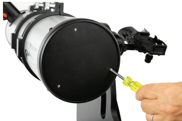
Abbildung 19a: Entfernen Sie beim 130 Tabletop Dobson die hintere Abdeckung der Spiegelzelle
